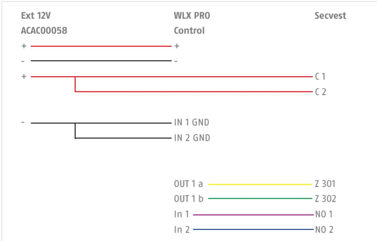
**Konfiguration der wAppLoxx Pro Control zur Schnittstelle Alarmzentrale Secvest**
